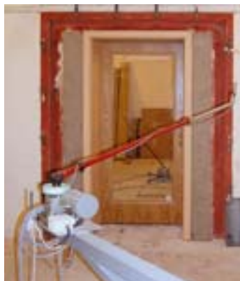
zkouška zvukové izolačních vlastností - jednokřídlé prosklené dveře
