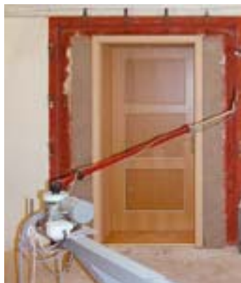
zkouška zvukové izolačních vlastností - jednokřídlé plné dveře
